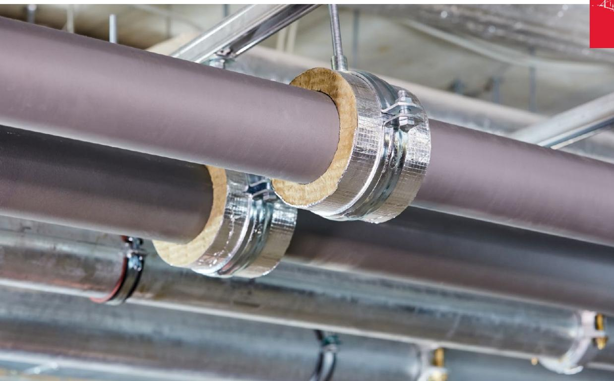
Der ROCKWOOL Rohrabhänger Teclit Hanger besteht aus einem sehr tragfähigen, hochdichten Steinwollekern und einer außenliegenden Befestigungsschelle. Der Steinwollekern sorgt für eine kältebrückenfreie Abhängung bei optimaler Lastverteilung. Zum diffusionsdichten Anschluss an die Rohrdämmung ist er mit einer sehr robusten glasfaserverstärkten Aluminiumfolie kaschiert und mit einem selbstklebenden Überlappungsstreifen ausgestattet.
