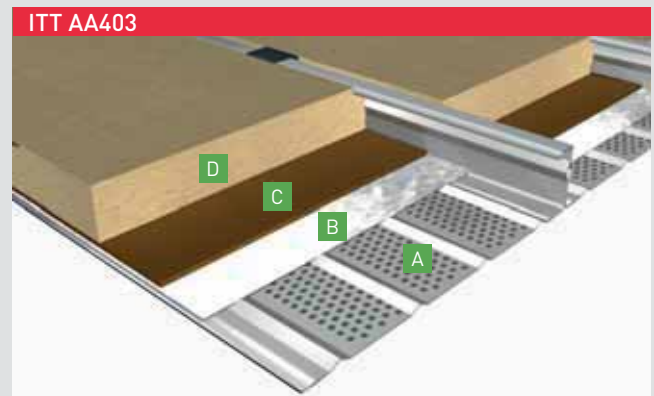
A Plateau perforé 15 % 92.500 1,25 mm B Pare-vapeur ROCKSOURDINE C Membrane pare-vapeur élastomère 2,6 mm [5 kg/m 2 ] D Isolant SOROCK 90 mm
