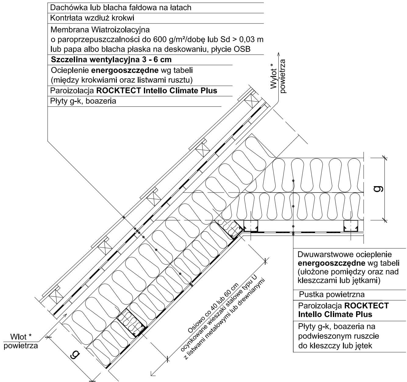
Energooszczędne ocieplenie dwuwarstwowe
