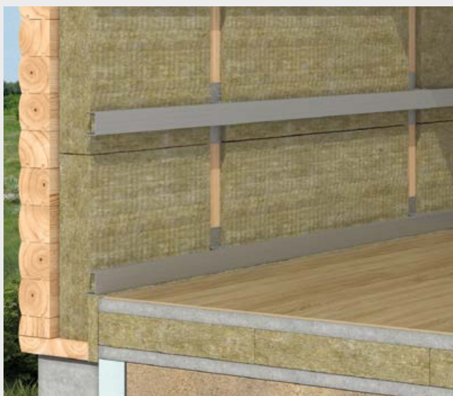
Mocowanie rusztu do słupków.
