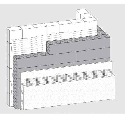
Nichtbrennbare Steinwolle-Lamelle für mineralische Wärmedämm-Verbundsysteme. Durch senkrecht zur Bauteiloberfläche ausgerichtete Wollstruktur hohe Druckund Abreißfestigkeit. Die Beschichtungen auf den Plattenoberflächen ermöglichen die maschinelle Verarbeitung des Klebemörtels auf dem Untergrund sowie den Putzauftrag ohne Pressspachtelung.
