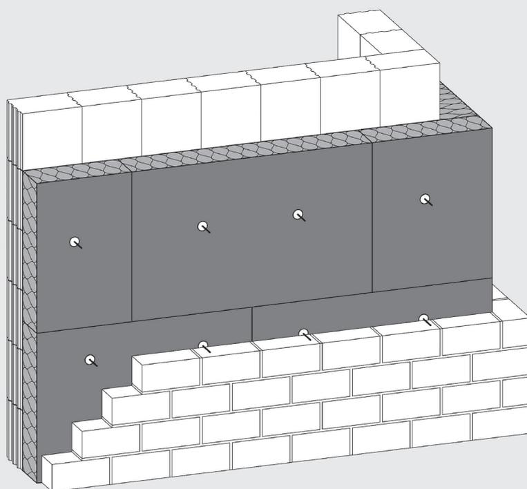
Formstabile Steinwolle-Dämmplatte\* mit einseitiger schwarzer Vlieskaschierung für die Kerndämmung im zweischaligen Mauerwerk. Auch bei einer freien Bewitterung von bis zu 3 Monaten ist die Platte nachgewiesen bewitterungsfest und behält ihre maßgeblichen Eigenschaften.
