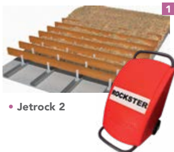
Par soufflage mécanisé
