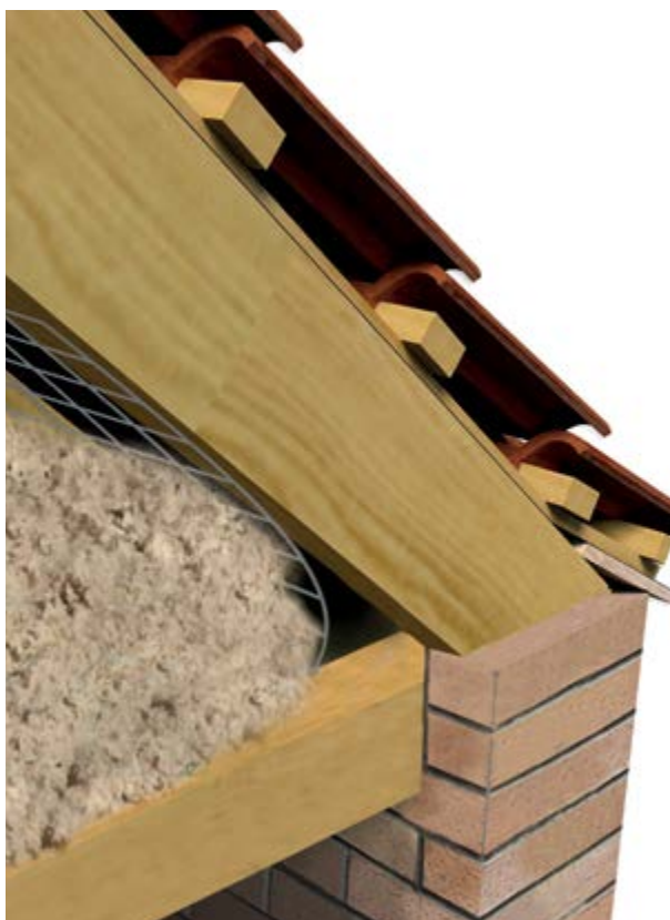
Découpe et pliage du grillage en correspondance des entrants (gauche) et maintien de l'aération (droite)
