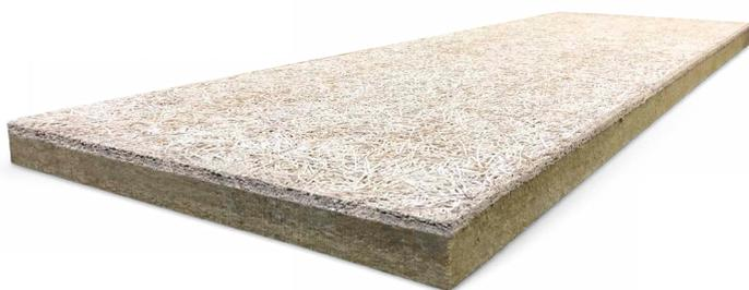
Panneau composite constitué d'une laine de roche double densité et d'un parement de 15 mm en laine de bois chanfreiné sur ses quatre côtés.
