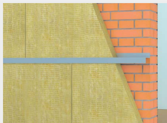
Akmens vates plātnes VENTIROCK SUPER / VENTIROCK PLUS tiek montētas starp horizontāliem tērauda termoprofiliem.
