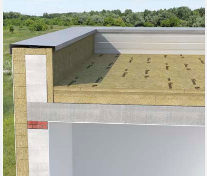
Układanie płyt zasadniczego ocieplenia na sucho.
