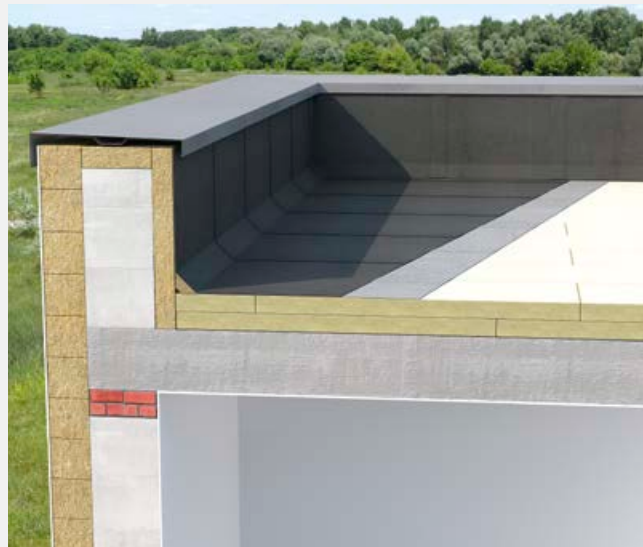
Zgrzewanie papy nawierzchniowej do papy podkładowej.
