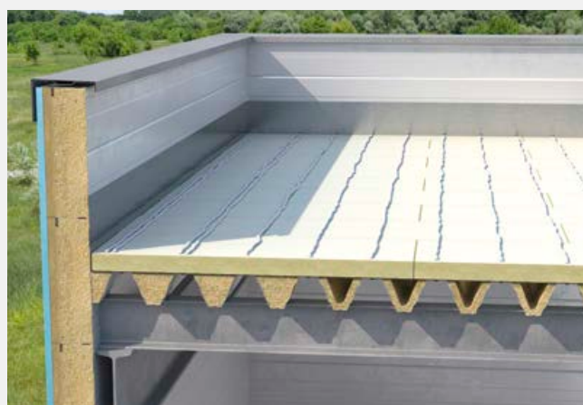
Przyklejenie pierwszej warstwy płyt HARDROCK MF PLUS do paroizolacji.
