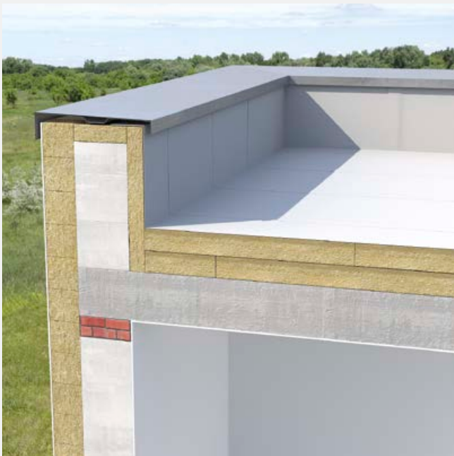
Membrana PVC zgrzewana na zakładkę.
