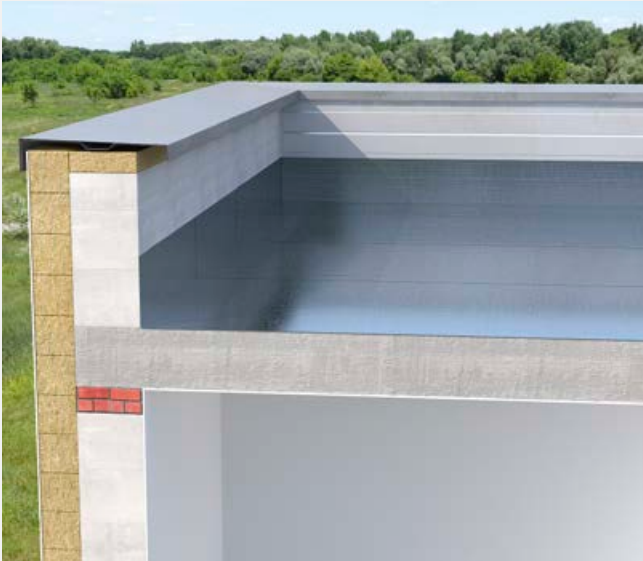
Paroizolacja samoprzylepna ROCKFOL SK 18234 II przyklejona do zagruntowanego podłoża betonowego.
